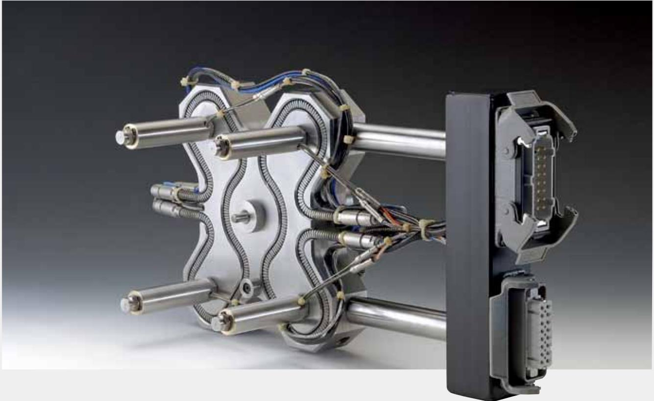
ドロップインシステムは金型に簡単に組み込み、安定した生産を保障するホットランナのひとつの形態です。ノズルはマニホール드에ねじ込まれ システムからの樹脂漏れを完全に防止するとともに段取り時間をほとんどゼロにします。システムはノズル、マニホールドとスプルーブッシュを組付け、完全な結線をコネクターボックスまで行った後出荷されます。従い、この完全なユニットをお客様で加工されたスペースに設置することにより極めて簡単に金型へ組み込むことができます。
