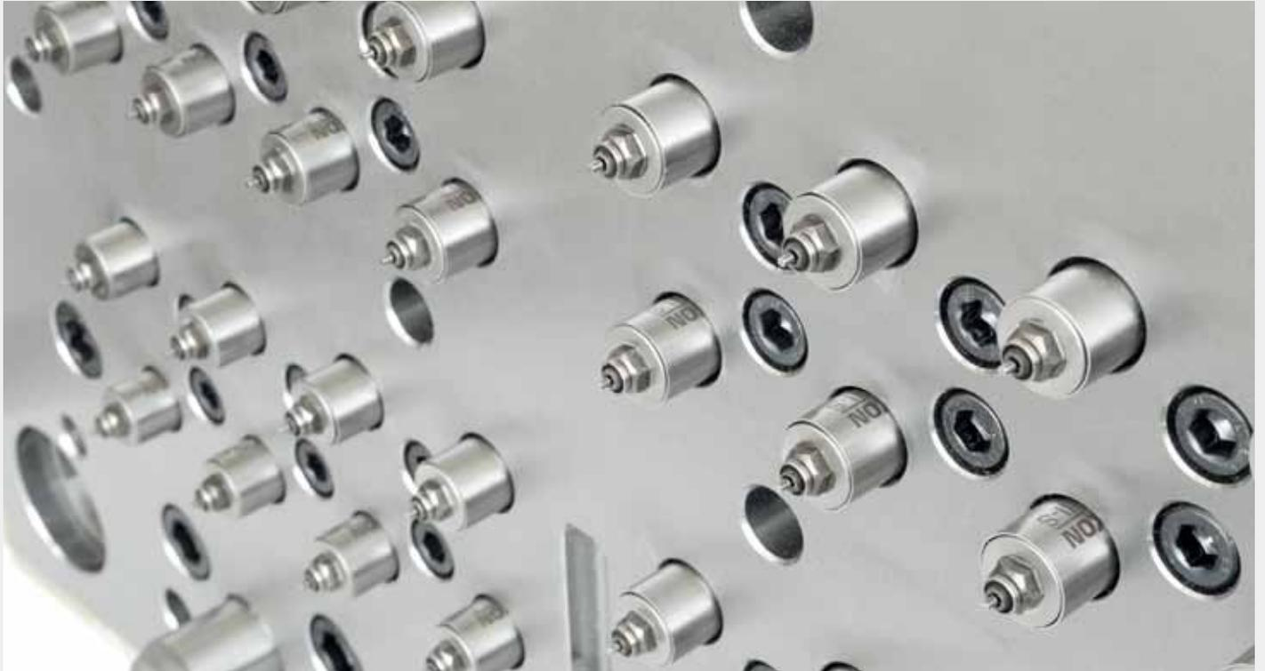
バルブゲートは成形品の優れた外観とともに格段に向上した成形の安定性を提供します。エビコンのバルブゲートシステムは複数の駆動オプションをもった様々な型式で用意されています。従って、お客様の個々のアプリケーションと金型のレイアウトに完全に合致したバルブゲートシステムを選択することができます。
