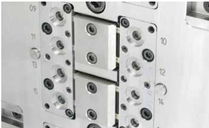
キャビティブロックを分割しない標準的な構造の金型設計
