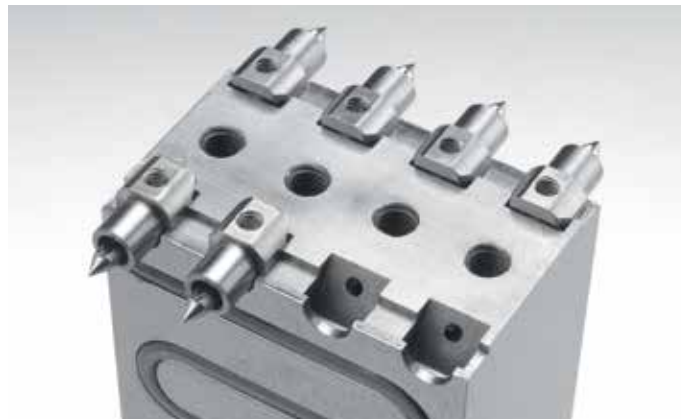
保守作業時に金型を分解せずにチップインサートを交換できる金型構造
