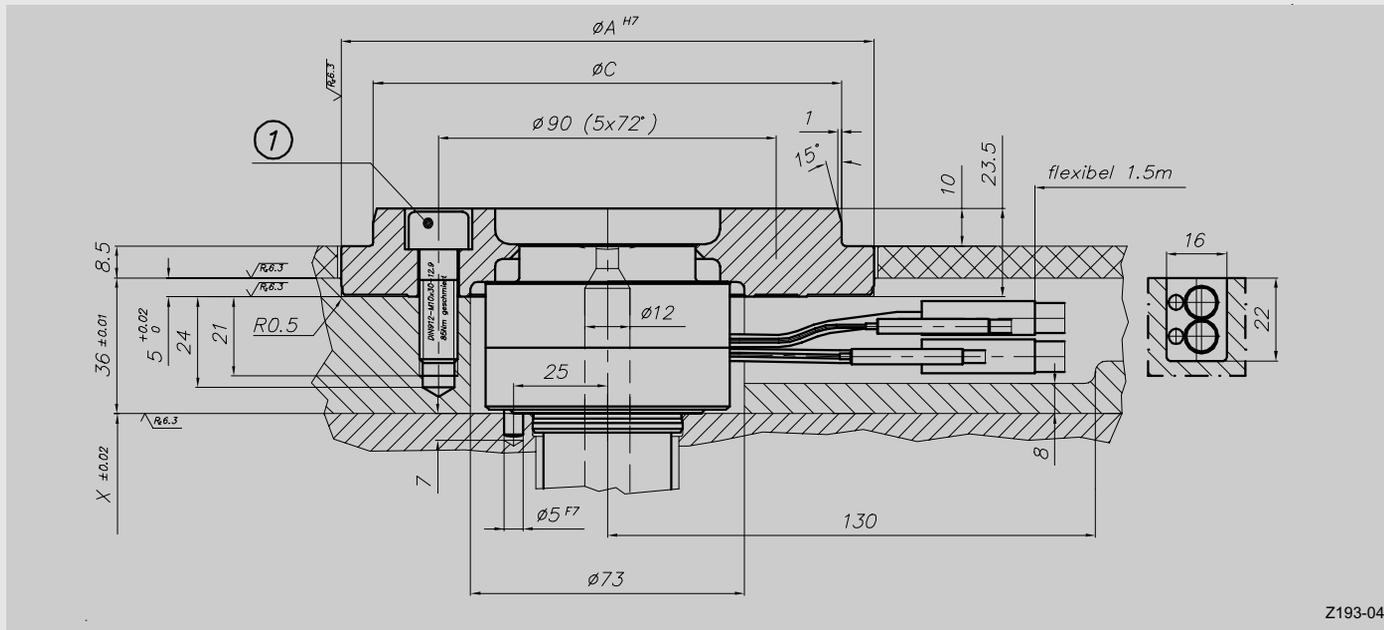
3回路制御のノズルの組込み (X寸法  $\geq$  250mm)
