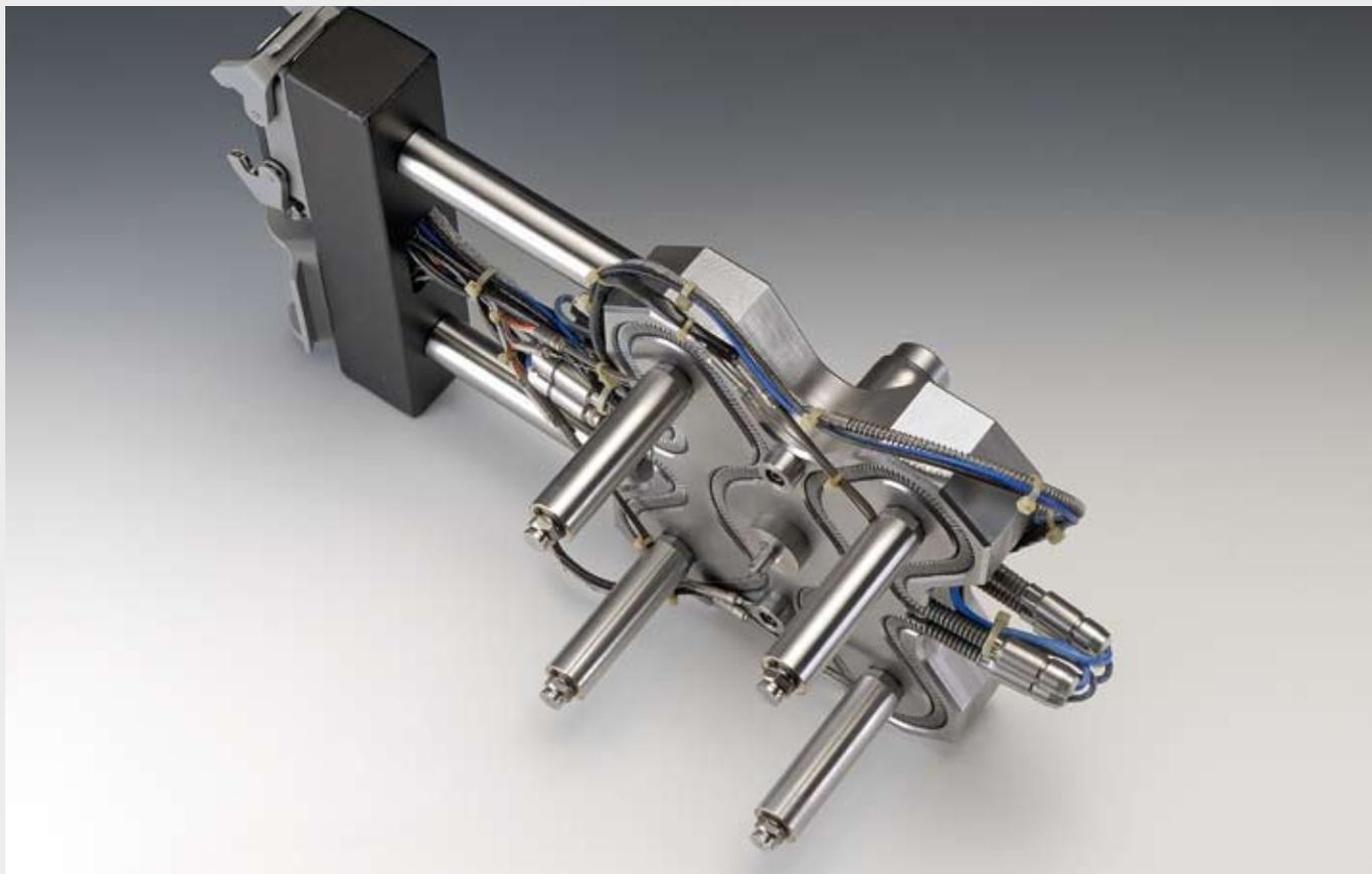
ドロップインシステムは金型に簡単に組込み、安定した生産を保証するホットランのひとつの形態です。ノズルは完全に樹脂漏れ防止、段取り時間を短縮するため、マニホールドにねじ込みで固定されます。システムはノズル、マニホールドとスプルーブッシュを組付け、完全な結線をコネクターボックスまで行った後出荷されます。従い、この完全なユニットをお客様で加工されたスペースに設置することにより極めて簡単に金型へ組込むことができます。
